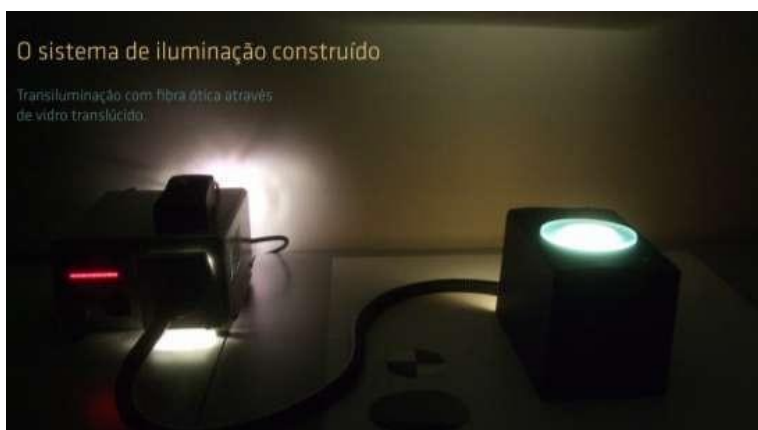
Figura 1. Sistema de iluminação construído. Transiluminação com fibra ótica através de vidro translúcido.
